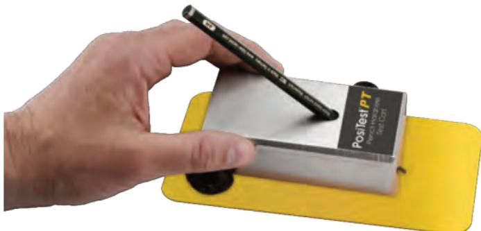
3. Falls erforderlich, führen Sie die Prüfung weiterhin durch, indem Sie bei jeder Prüfung die Härteskala hinabgehen, bis ein Bleistift die Beschichtung nicht zerkratzt oder entstellt. Dieser Bleistift wird als Kratzhärte gemeldet.
