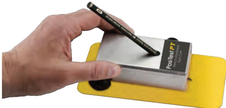
3. Si nécessaire, poursuivre le test, en descendant l'échelle de dureté à chaque test, jusqu'à ce qu'un crayon ne rase pas ou ne dégrade pas le revêtement. Ce crayon est signalé comme la dureté de rayure.
