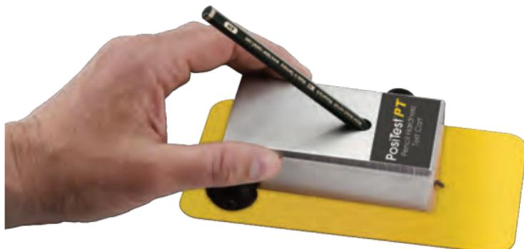
3. Si es necesario, realice más pruebas bajando la escala de dureza en cada una hasta que no raye ni altere el recubrimiento. Este lápiz se indicará como la dureza de gubia.
