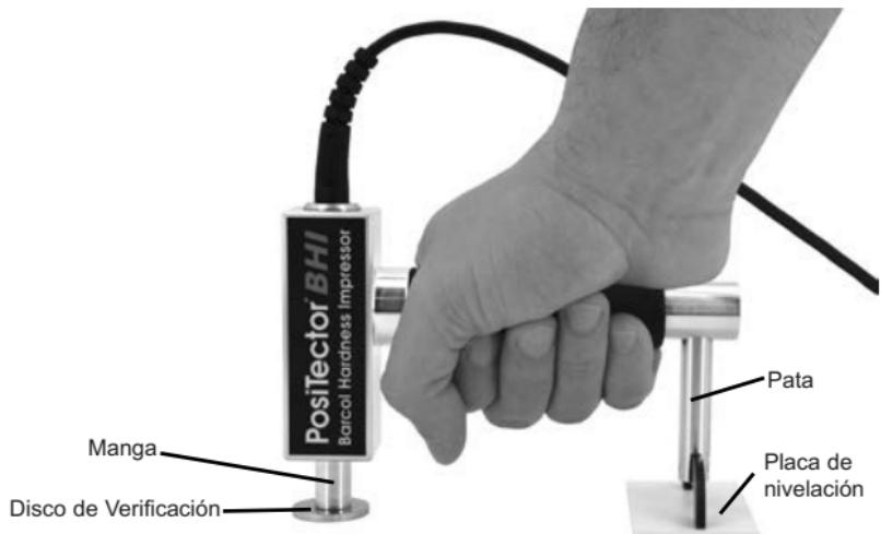
Algunas de las causas para que el medidor no lea correctamente son daños en la punta, presión incorrecta aplicada al bloque de prueba o temperaturas que no se consideren condiciones normales.
