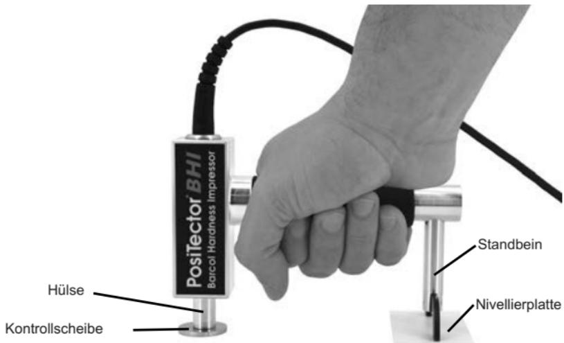
Führen Sie auf jeder Kontrollscheibe jeweil drei bis fünf Messungen durch. Die Messpunkte sollten dabei mindestens 6 mm voneinander entfernt sein. Falls der Durchschnittswert dieser Messungen auerhalb der kombinierten Genauigkeit von den Kontrollscheiben und der des Messgerätes liegt, sollten Sie das Gerät vom Hersteller überprüfen lassen.
