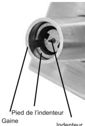
Vérifiez la précision (page 3) sur les disques d'essai au début et à la fin de chaque équipe de travail, ou si l'instrument est tombé ou est susceptible de donner des lectures erronées. Assurez-vous de placer la jambe sur la plaque de mise à niveau incluse lorsque vous testez des disques afin de s'assurer de la perpendicularité de l'ensemble.
