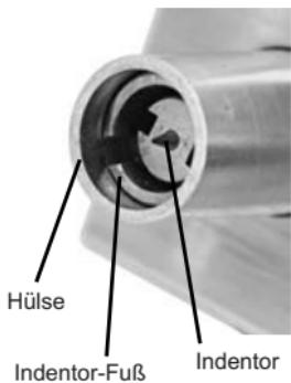
**3.** Heben Sie die Sonde zwischen den Messungen von der Oberfläche ab.
